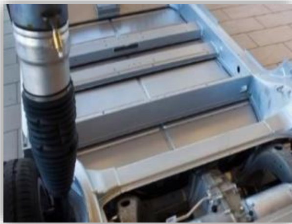
Estructura mecánica de un paquete de baterías
