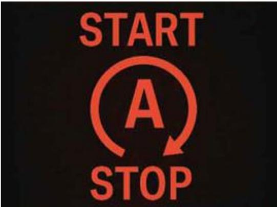
Inicialmente un sistema manual se ha convertido en un sistema totalmente automática que apaga el motor del coche cuando este se para. El motor se reinicia automáticamente al soltar el freno o presionar el acelerador o embrague dependiendo del tipo de transmisión. Los sistemas de parada y arranque podrían ser desconectados manualmente, pero en la próxima generación de vehículos se ha deshabilitado esta opción.
