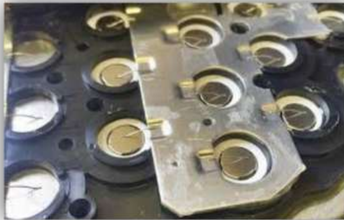
Spojenia elektrických článkov k Bus Bar
